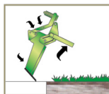
A haste rearma com o levantamento do implemento.
